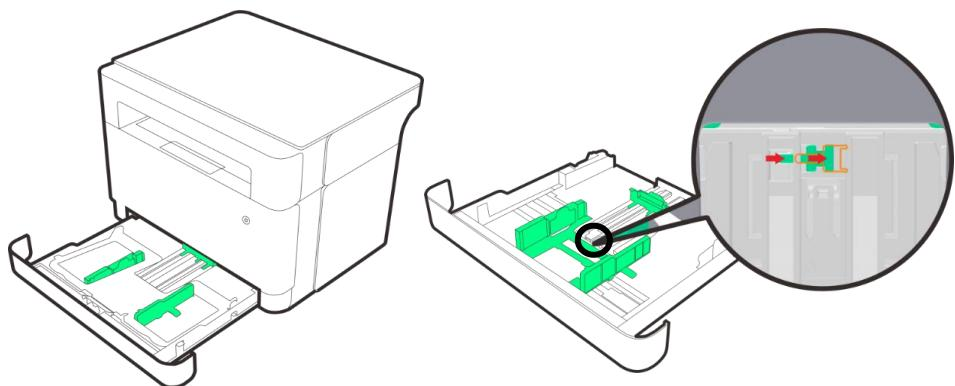
4、然后捏住纸张宽度卡板，将纸张宽度卡板移至最大位置（例如A4卡位位置锁定）。
