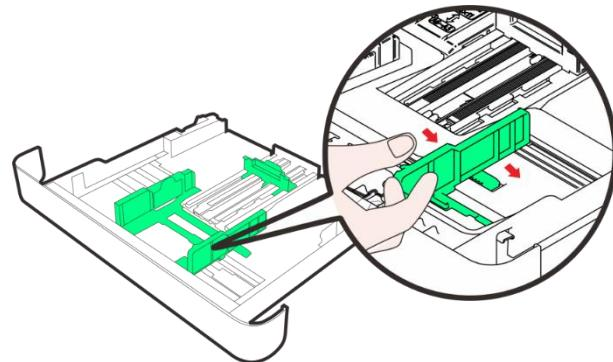
5、装入纸叠，打印面朝下，不要装入太多的纸。给纸盒最大可装 150 张 (80g/m<sup>2</sup>) 纸，
